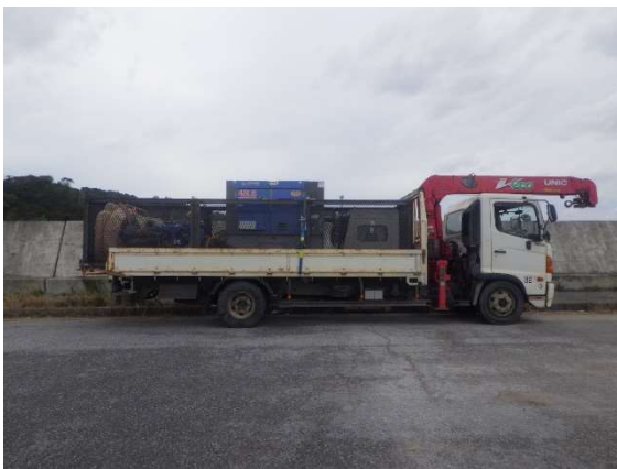
搬入資機材 4t ユニック車1台
