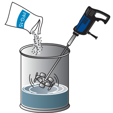
③ PFG-15を投入して練り混ぜ3分
