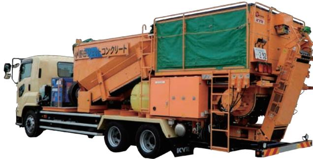
重量計量のバッチ式移動プラント車による
